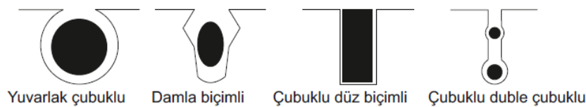
Şekil 2. Rotor çubuk biçimi ve kesiti
